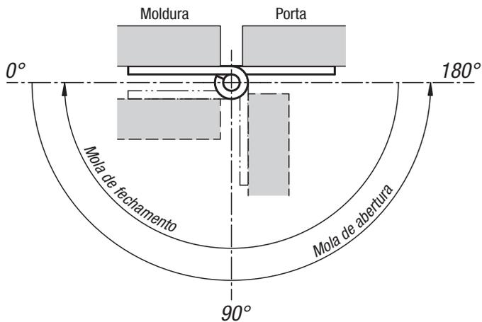
Desenvolvimento do torque das dobradiças com mola, conforme a posição de ângulo:
